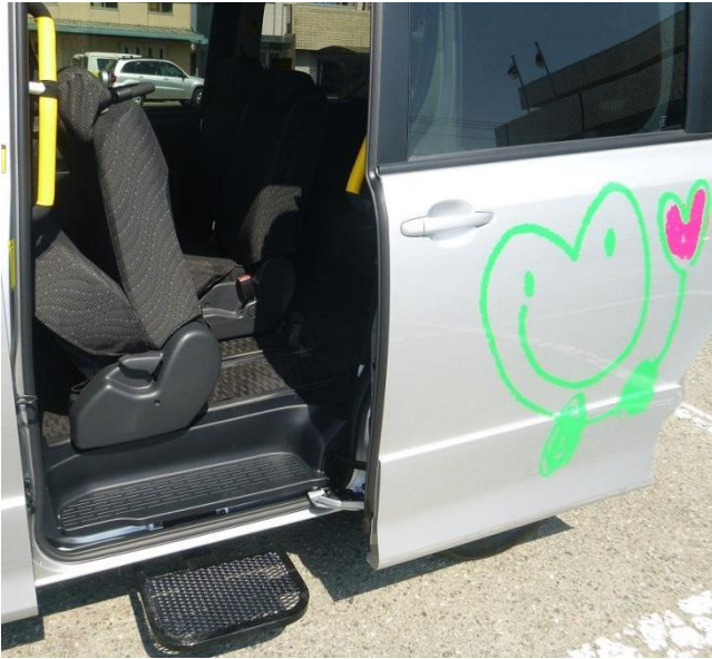
手すり及びオートステップ
